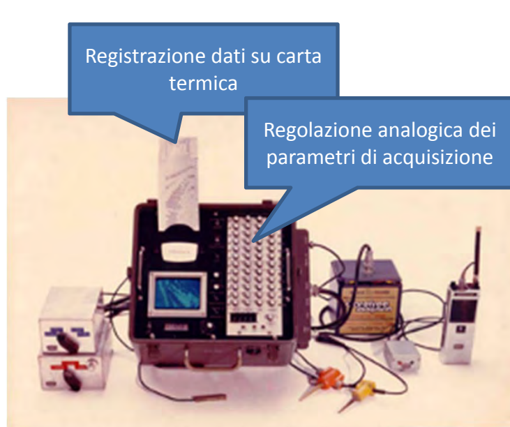
Sismografo per sismica a rifrazione a 6 canali Geometrics ES-1224 1977 – 1987 (immagine fornita da Progeo Srl)
